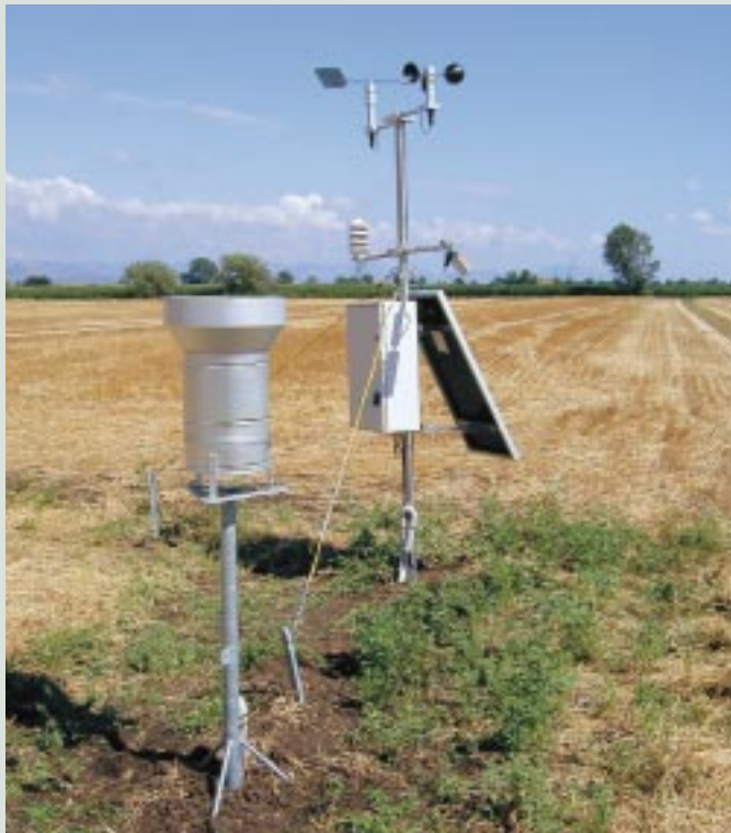
▲ Centralina meteo. Temperatura e umidità relativa possono essere parametri utili per prevedere lo sviluppo di una malattia in base ai vari modelli previsionali. In coltura protetta bisogna però conoscere le differenze di temperatura e di umidità tra ambiente coperto e ambiente esterno in quanto le differenze possono rappresentare il fattore scatenante dell'epidemia. (Foto DigitEco s.r.l.)
